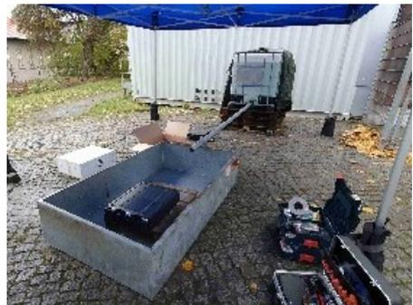
(b) Schutzmaßnahmen für die Zerlegung von Akkumulatoren
