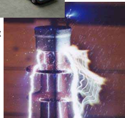
Überschlag an einem Stützer
