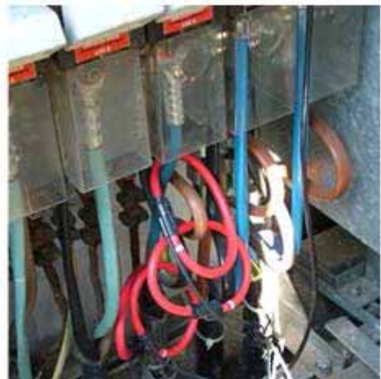
Bild 1: Positionierung der Rogowskispulen bei einer Feldmessung
