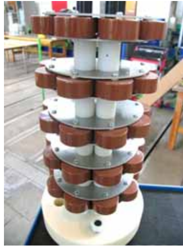
Bild 3: Versuchsstand und Marxgenerator
