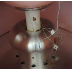
Bild 5: Thermoelemente an der Elektrode und dem Isolator im Prüfgefäß zur Messung der Temperaturverteilung
