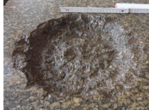
Bild 5: 12 1/4"-Bohrung in Granitstein
