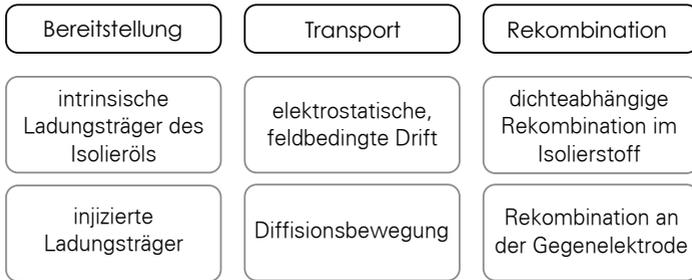
Bild 1: Ladungsträgerbasierte Leitfähigkeitsmechanismen im Dielektrikum
