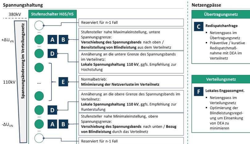
Bild I: Anwendungsfälle zur koordinierten Blindleistungsbereitstellung
