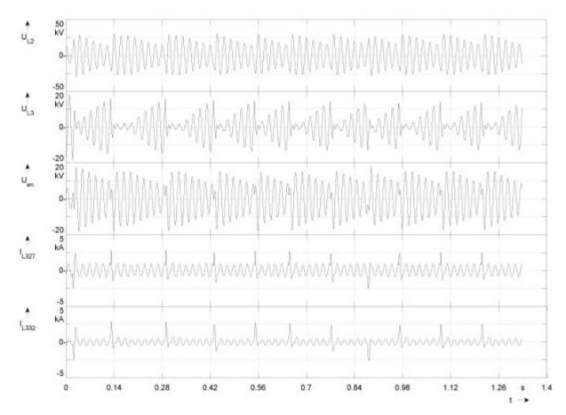
Bild 1: Wiederzündender Lichtbogen bei 1 cm Elektrodenabstand und 10 % Überkompensation in einem 20-kV-Mittelspannungsnetzausläufer, aufgezeichnet im entfernten UW
