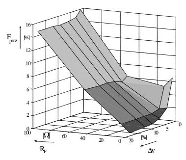
Bild 2: Prozentualer Fehler als Funktion von Fehlerwiderstand und Verstimmungsgradänderung (Kabel)
