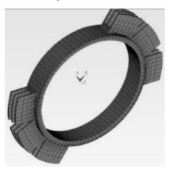
Bild 3: Leiter mit angeschraubten Kühlelementen
