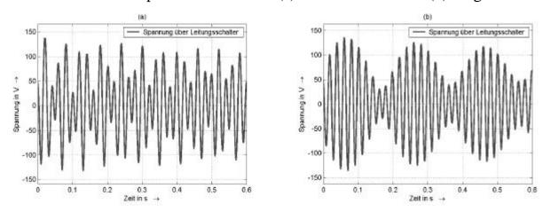
Bild 1: Spannung über dem offenen Schalterpol nach einer Kurzunterbrechung auf einer parallelkompensierten Freileitung; (a) Kompensationsgrad 30 %, (b) Kompensationsgrad 80 %
