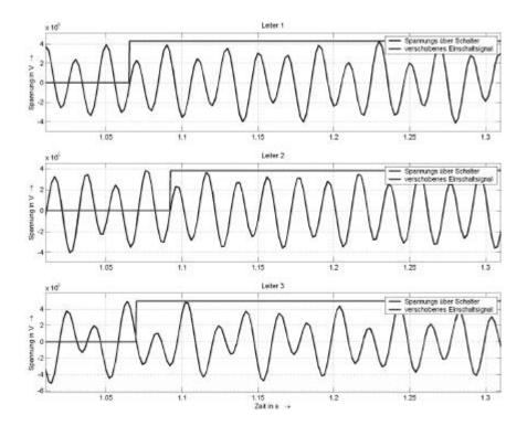
Bild 2: Spannung über den Schalterpolen und berechnetes Einschaltsignal für eine dreipolige Kurzunterbrechung
