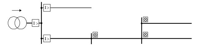
Bild 2: Vereinfachtes Überstromschutzsystem mit Kurzschlussanzeigern
