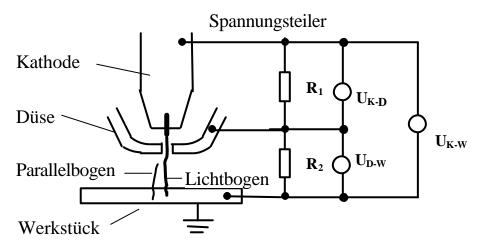
Bild 1: Schaltbild zur Messung der Spannung zwischen Düse und Werkstück  $U_{D\text{-}W}$  bei unterschiedlichen treibenden Spannungen  $U_{K\text{-}W}$
