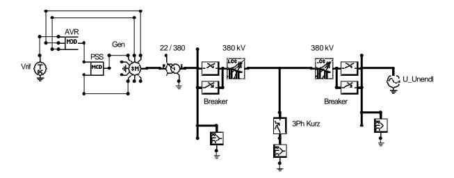
Bild 1: Einfaches Testnetz mit Regelung
