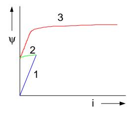
Bild 1: Verlauf des Flusses bei einer erfolglosen AWE
