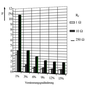
Bild 1: Prozentualer Fehler als Funktion von Fehlerwiderstand und Verstimmungsgradänderung (Freileitung)
