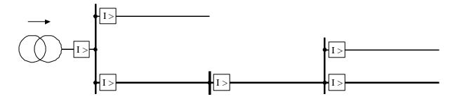
Bild 1: Überstromzeitschutzsystem für ein Mittelspannungs-Strahlennetz
