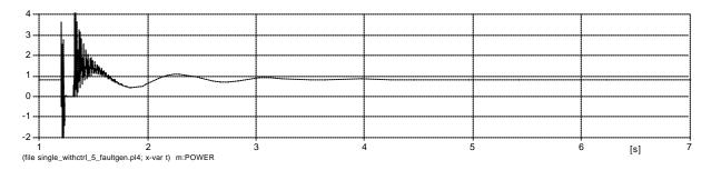
Bild 3: Wirkleistung des Generators mit AVR und PSS Regelung
