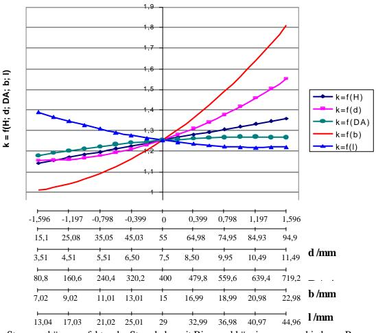
Bild 2: Stromverdrängungsfaktor der Strombahn mit Rippen abhängig von verschiedenen Parametern: H, d, DA , b, l.
