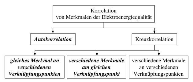
Bild 1: Varianten der Korrelation
