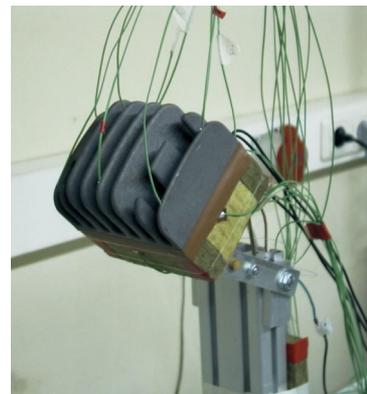
Bild 1: Kühlkörper 1 mit Thermoelementen
