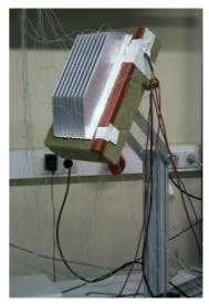
Bild 2: Kühlkörper 2 mit Thermoelementen
