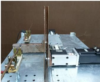
Bild 2: Automatisierte Elektrodenachführung
