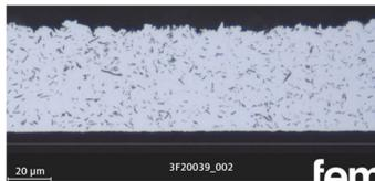
Bild 3: Ag-hBN-Dispersionsschicht mit 7,3 Vol.-% hBN und einer Partikelgröße von 35 µm
