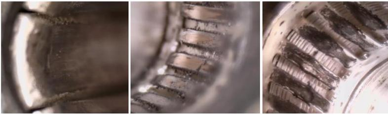
Bild 2: Im realen Einsatz vorgefundene Fremdschichten und Reibverschleiß an AC-Ladesteckern.
