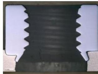
Bild 2: Schliffbild durch ein Funktionselement (Einnietmutter).
