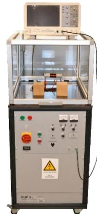
Bild 3: Rechteckimpulsspannungsgenerator, Entwicklung durch GBS Elektronik GmbH Radeberg
