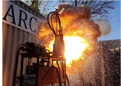
Bild 4: DC-Störlichtbogen am NARC an Box-Textanordnung bei Versuchen mit der TU Ilmenau
