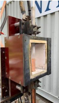
Bild 1: Störlichtbogen-Versuchsanordnung nach IEC 61482-1-2
