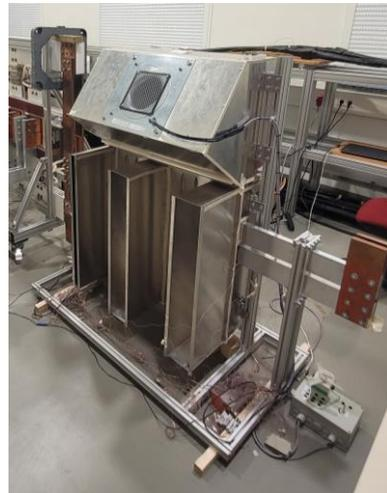
Bild 1: Nachbildung der untersuchten Stromschienenkonfiguration in einem AC/DC-Konvertermodul
