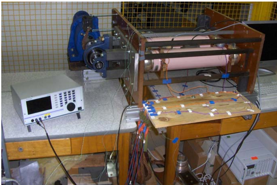
Bild 2: Versuchsstand - Gleitverschleiß an Steckverbindungen mit Schraubenfedern
