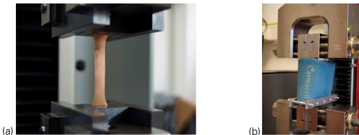
Bild 1: Prüfaufbau zur Durchführung der Zugversuche bei a) RT und b) in \text{LN}_2
