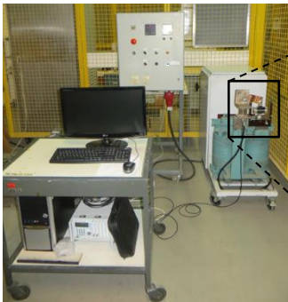
Bild 2: Versuchsaufbau mit Hochstrom-Transformator und Steuerung
