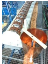
Bild 2: Impulsspannungsgenerator und geschirmter Messteiler
