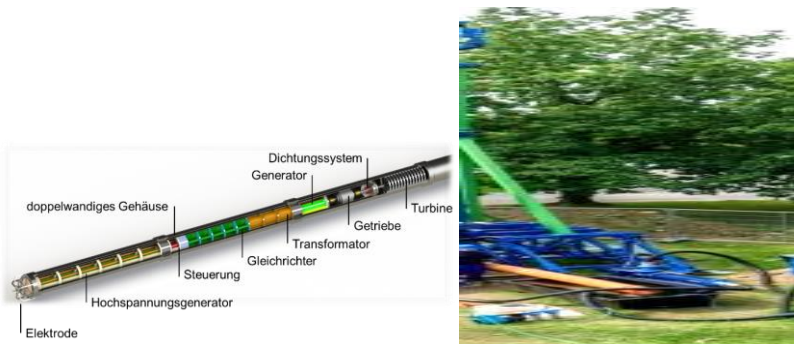
Bild 1: Modell des Bohrsystems und in-situ-Versuchsstand an der TU Freiberg
