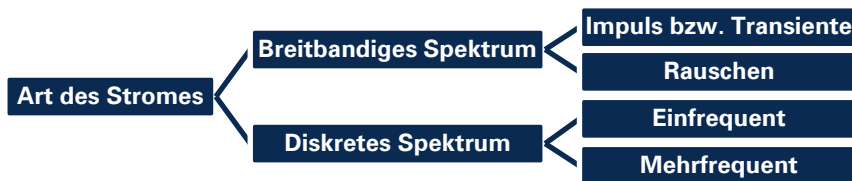
Bild 1: Unterteilung bekannter Messverfahren nach Art des Anregestromes
