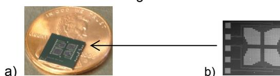
Abb.: Sensorarray (8x8x0,4 mm<sup>3</sup>)
