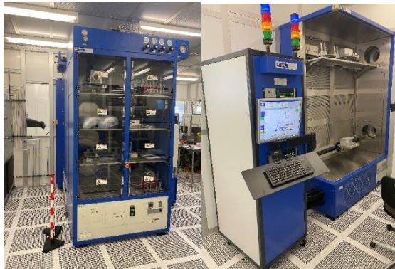
Abbildung 3 Hochtemperaturanlage für Feuchtoxidation mit \text{H}_2 -Verbrennung sowie für Trockenoxidation mit HCl-Strecke mittels Trans-LC-Verfahren.
