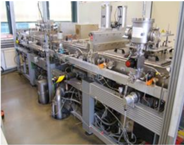
Abbildung 1 Forschungsanlage mit integrierter VHF-PECVD, RF-PECVD, HWCVD im dynamischen Betrieb mit linearen Beschichtungsquellen.
