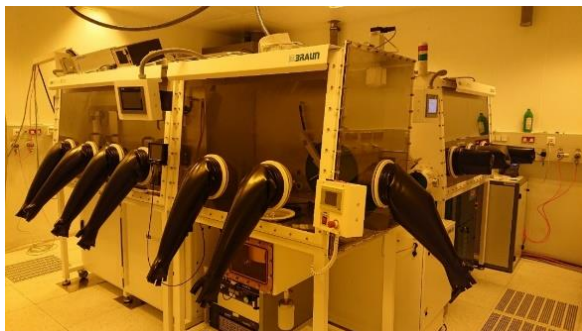
Abbildung 9 Glovebox Anlage mit integrierter ALD-, Sputter- und Verdampferanlage im Reinraum Werner-Hartmann-Bau
