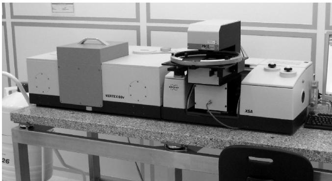
Bruker Vertex 80v FTIR-Spektrometer (li.) mit der Pike-Map300-Einheit in der Zusatzprobenkammer XSA (re.)
