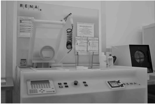
Galvanische Kupferabscheidung auf 4"- bis 8"-Wafern (Prozessmodul mit geneigt rotierendem Wafer, Prozesse mit Opfer- als auch dimensionsstabilen Anoden und entsprechenden Bädern)
