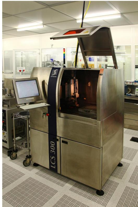
LCS 300, Fa. Synova, ; Trennen von Si-Wafern bis 300 mm Durchmesser
