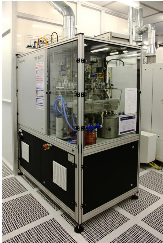
BENEQ TFS 500; Fa. Beneq, Finnland, Heißwandreaktor; Einzelwaferbearbeitung bis 200 mm; Prozesse zur Abscheidung von  $\text{Al}_2\text{O}_3$ ,  $\text{TiO}_2$ , Ti-N-O, Ir,  $\text{IrO}_2$  und  $\text{SiO}_2$
