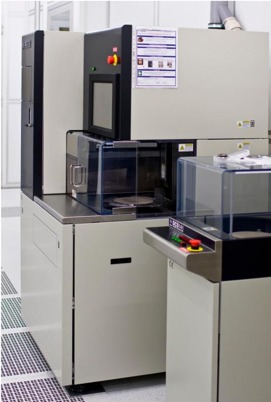
DAD 3350, Fa. Disco, Japan; Trennschleifen von Si-Wafer, Glas, Keramik, Quarz, Saphier bis 200 mm Durchmesser
