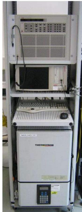
Zuverlässigkeitsmessplatz für Package-level Tests
