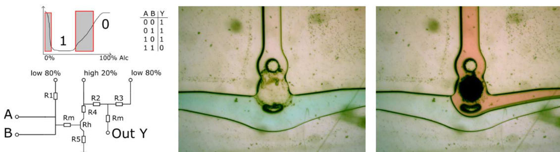
Abbildung: Konzept eines planaren mikrofluidischen NAND-Gatters mit hydrogelbasiertem Schaltelement.
