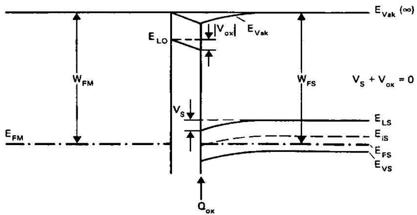
MOS-Struktur mit  $Q_{ox} > 0, \Delta W_F = 0$  im thermodynamischen Gleichgewicht
