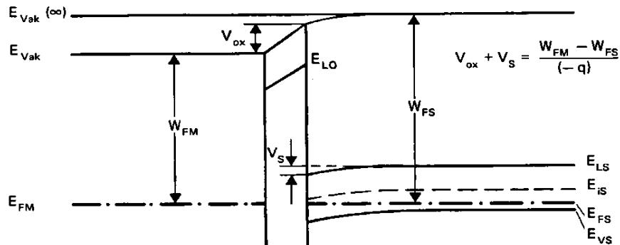
MOS-Struktur mit  $\Delta W_F \neq 0$  im thermodynamischen Gleichgewicht
