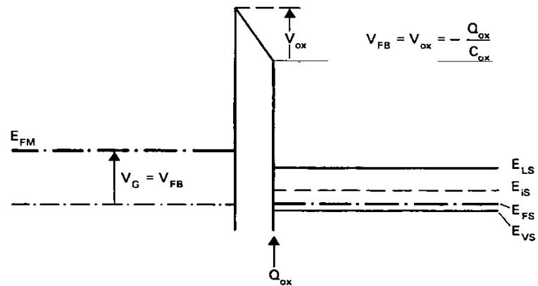
MOS-Struktur mit  $Q_{ox} > 0, \Delta W_F = 0$  im Flachbandzustand
