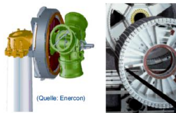
Windkraftgeneratoren mit 1,5MW als mechatronischer Direktantrieb
