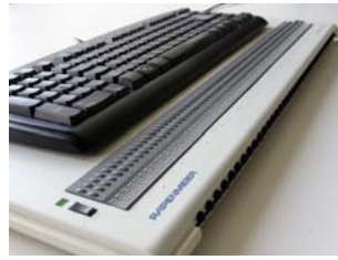
b) Papenmeier Braillezeile mit Navigationsleiste und Routingtasten
