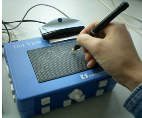
b) Mimizu System bestehend aus DotView Display und Ultraschallstift 29
