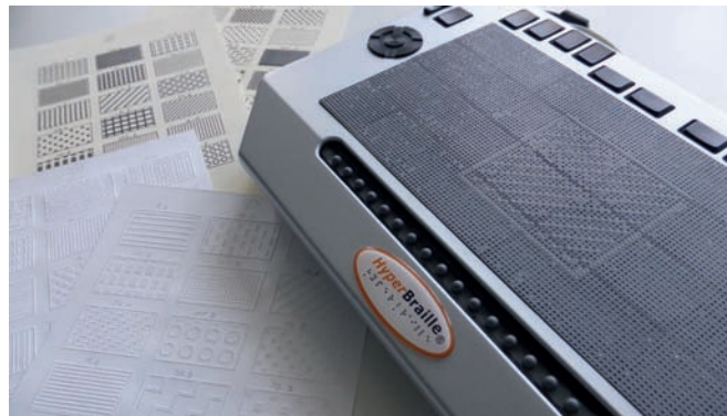
Abbildung 7.13: Beispiel eines Referenzmusters auf der Stiftplatte und Übersichtspaletten mit allen Texturvarianten als Schwellpapier- und Brailleausdruck
