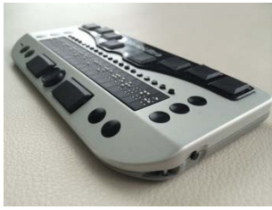
a) VarioUltra Braillezeile mit Notizgerätefunktion und Brailletastatur 19
