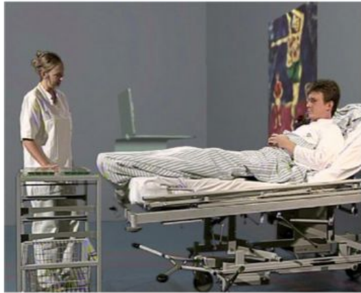
Abbildung 2: Interaktives Bett, das Patienten erkennt und dem Personal Daten auf einem Rechner präsentiert (links), ortsunabhängige Konferenz zu einer Röntgenaufnahme auf einem Wand-Display (rechts) [Bar03]
