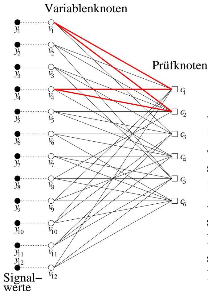
Jede(s) Variable (Bit)  $v_j$  ( $u_j$ ) ist in drei Prüfgleichungen enthalten, korrespondierend zu den drei Einsen in jeder Spalte.
