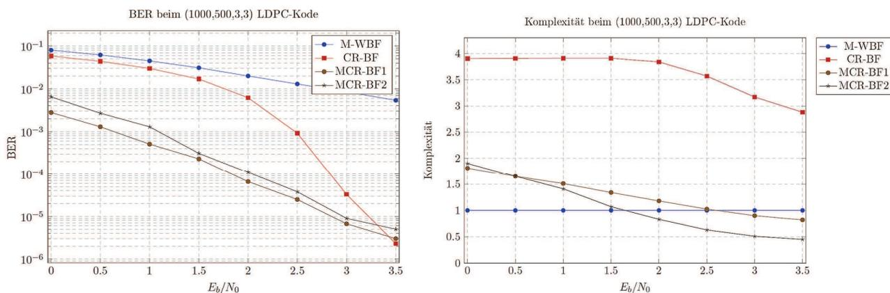
→ modifizierte Versionen (MCR-BF1, MCR-BF2) kippen in Abhängigkeit von  $w(s)$  mehrere Bits
