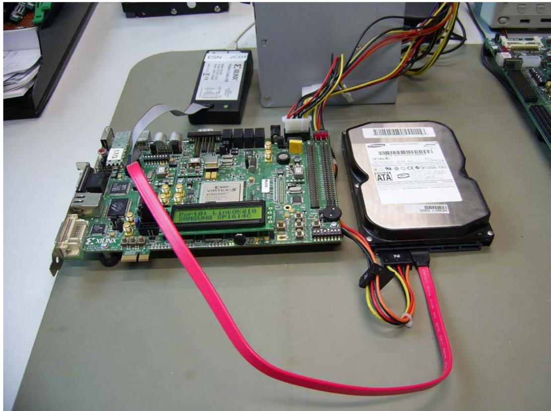
Versuchsaufbau aus: ML505 Developer Board, Samsung SP1, Xilinx Programmer und ATX Netzteil
