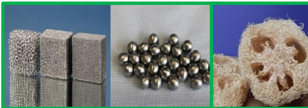
Verschiedene Trägermaterialien für die Immobilisierung von Enzymen (Metallschaum, poröse Metallkugeln, Luffa). (© Annett Werner)
