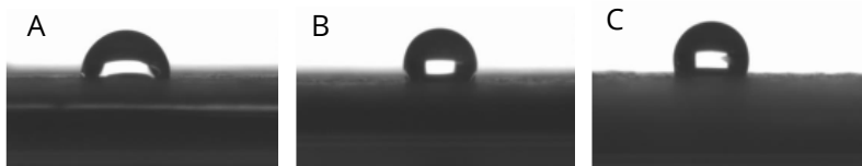
Abbildung 1: Kontaktwinkelmessung zur Ermittlung des Benetzungsverhaltens der Probe mit Wasser mit A- 0 %, B- 5 % und C- 10 % Phytoextrakt imprägnierter Rotbuche
