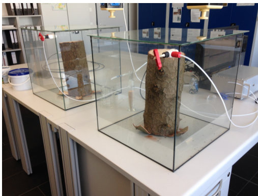
Abb. 2: Laboraufbau zum Aufnehmen von Geruchsproben, © TUD
