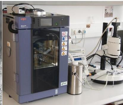
Abb. 2 Messstände für die Vereisung unter definierten Bedingungen
