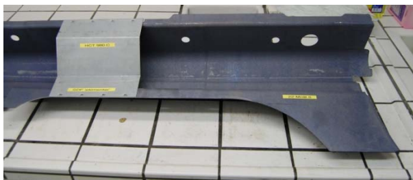
Realbauteil PKW-Schweller 22MnB5 pressgehärtet und geclincht
