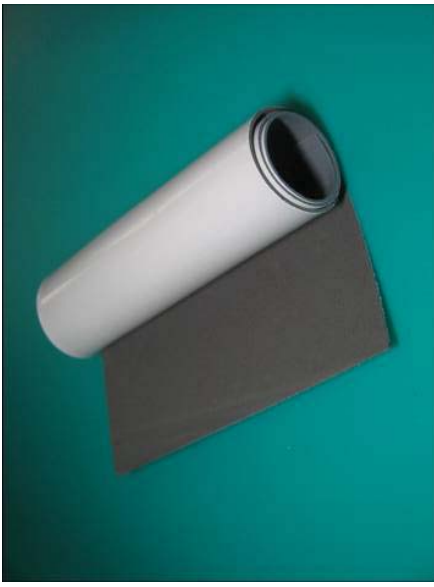
Stahl-Keramik-Verbundfolie im Grünzustand
