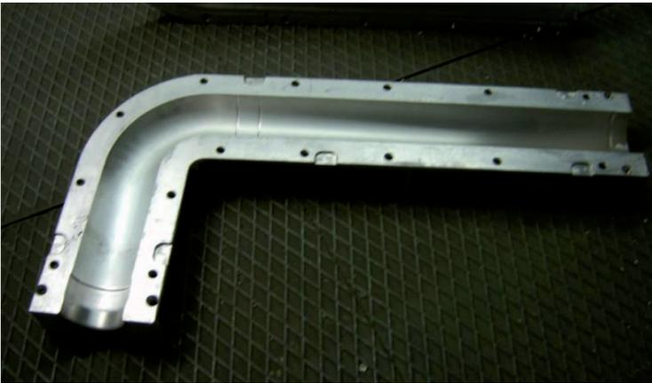
*Abb.: Beispiel einer gegossenen Werkzeughälfte*
