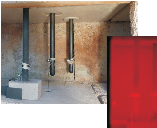
Abb.: Test von keramischen Wärmerohren (Heatpipes) im Heißgasprüfstand
