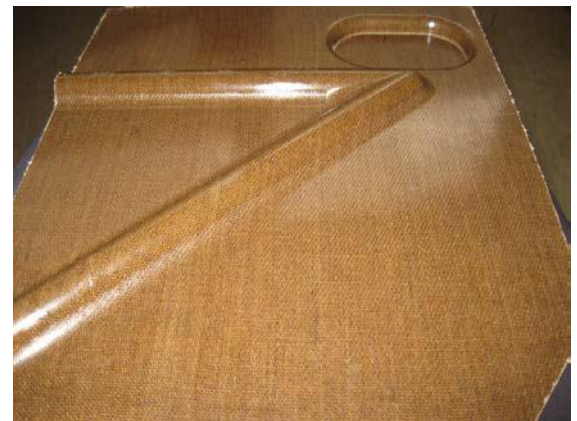
Bild: Formteil aus biobasiertem Naturfaser-Organoblech, Bildquelle: TU Dresden, IHP
