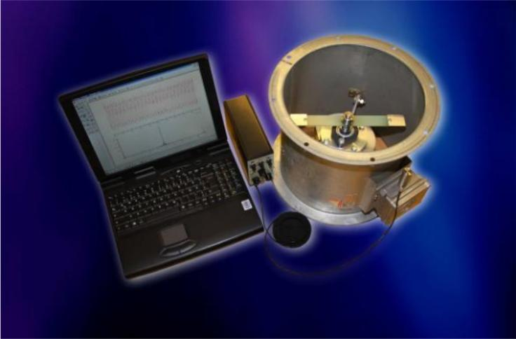
Schleuderprüfstand zur Bestimmung der Eisadhäsion
