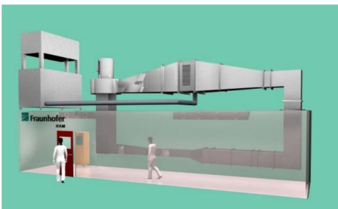
Bild links: 3D-Animation des Eislabors mit integriertem Vereisungswindkanal der Fraunhofer IFAM
