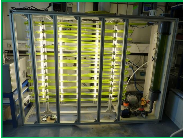
Versuchsanlage der MINT GmbH zur Mikroalgenkultivierung am Institut für Naturstofftechnik der TU Dresden. (©Krujatz)
