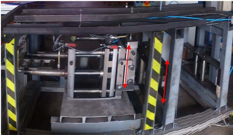
Abb. 1: Grundauführung von links nach rechts: Greifer- und Vorschubeinheit, Werkzeugeinheit, Führungseinheit
