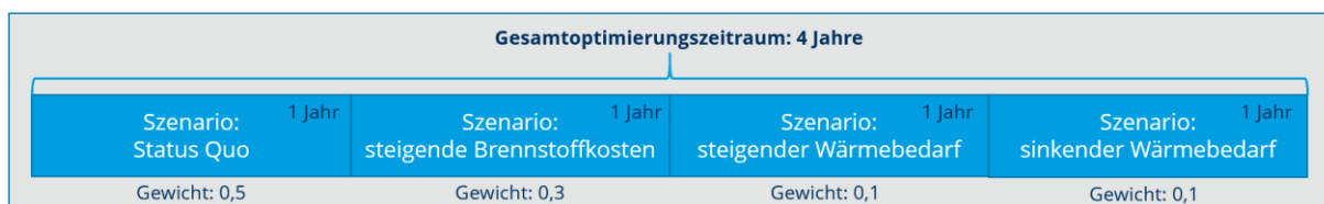
Abbildung 36: Betrachtung unsicherer Randbedingungen durch geschlossene Optimierung der Aneinanderreihung verschiedener Szenarien.
