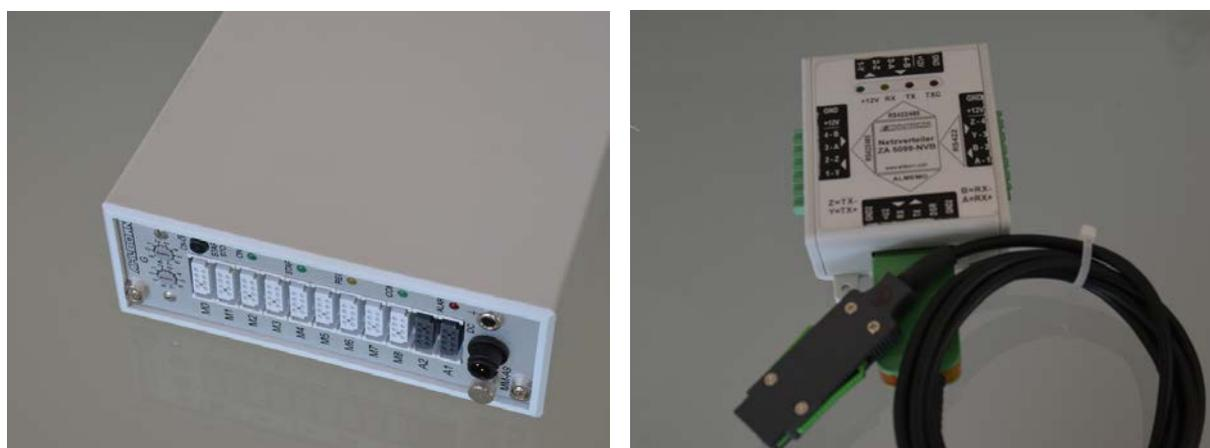
Abbildung 12 BTM-Datenlogger (links) sowie Netzwerkverteiler (RS422/485) (rechts)
