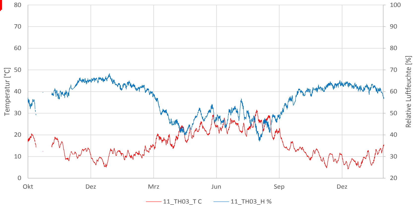
Temperatur und relative Luftfeuchte Haus 1, Messpunkt 3 - Kleberebene Wand
