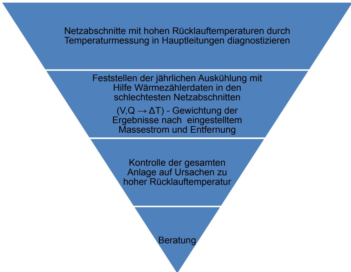
Bild 2-4 Bearbeitungspyramide: Feststellung von Kundenanlagen mit dem größten Potential
