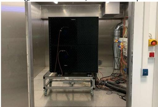
Abbildung 1: Wärmepumpe in Klimakammer
