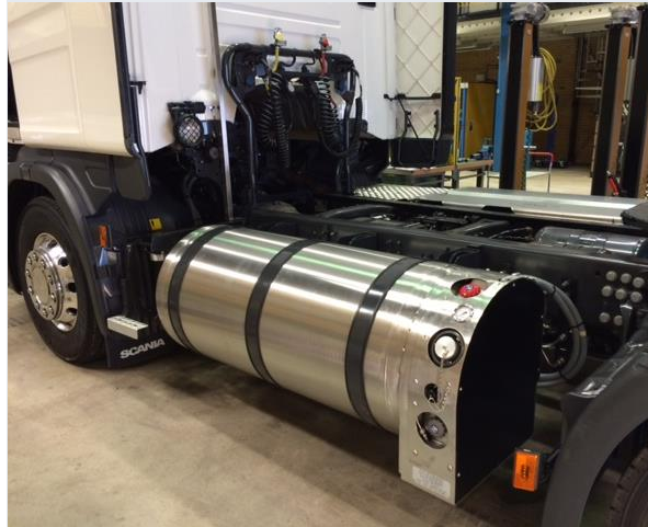
LNG-Kryotank von SAG (aufgebaut in LKW)
