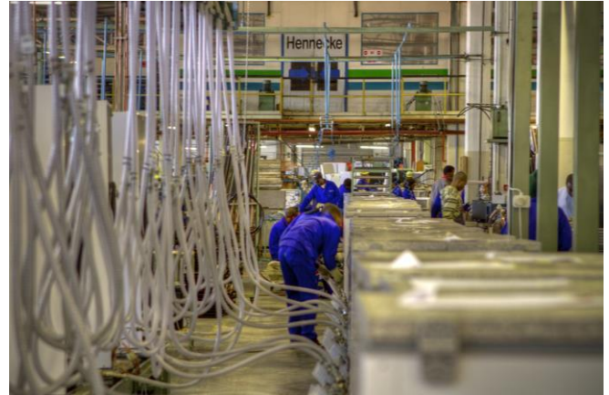
Final Assembly: Schäumenanlage, Montage und Evakuierung ©TFF
