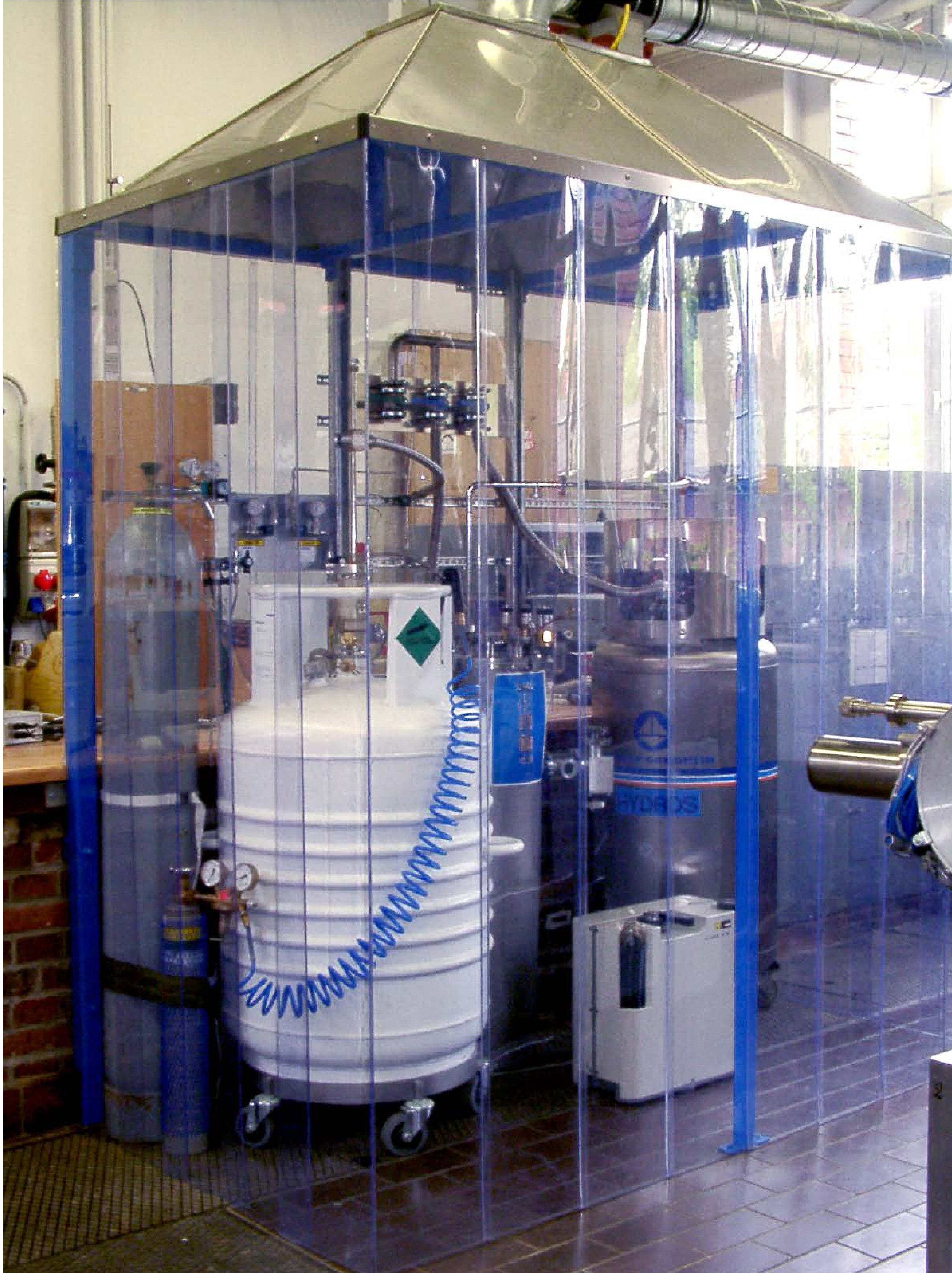
Schutzzone mit Abzugshaube und Lamellenvorhang
