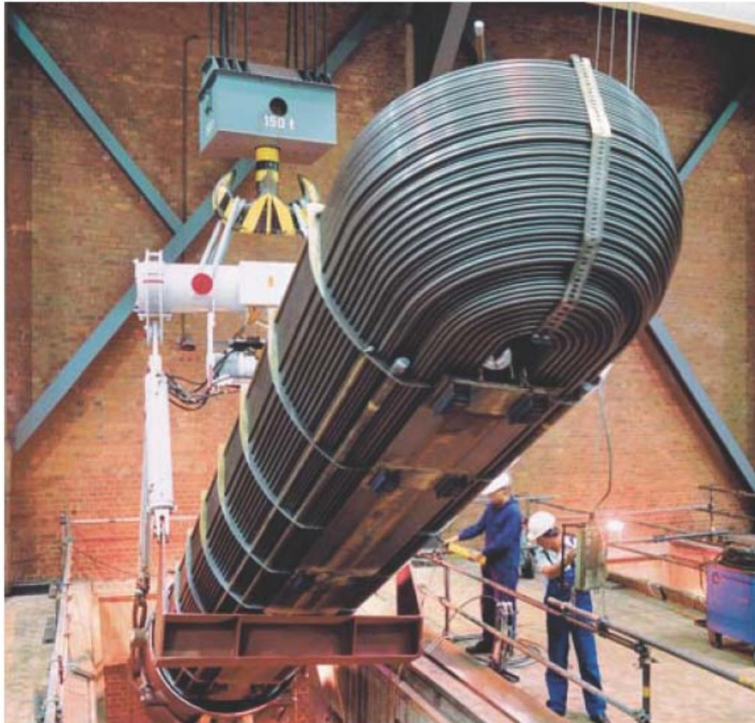
*Rohrbündel eines Duplex-Vorwärmers*
