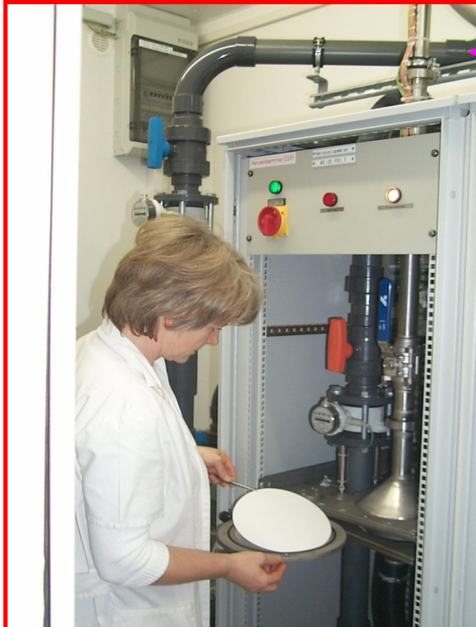
HEPA-Filterwechsel für die Labormessung von Aerosolen
