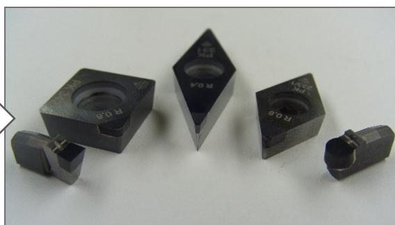
Abbildung 5: Ausgewählte Drehwerkzeug mit BNNC-Schneideinsätzen
