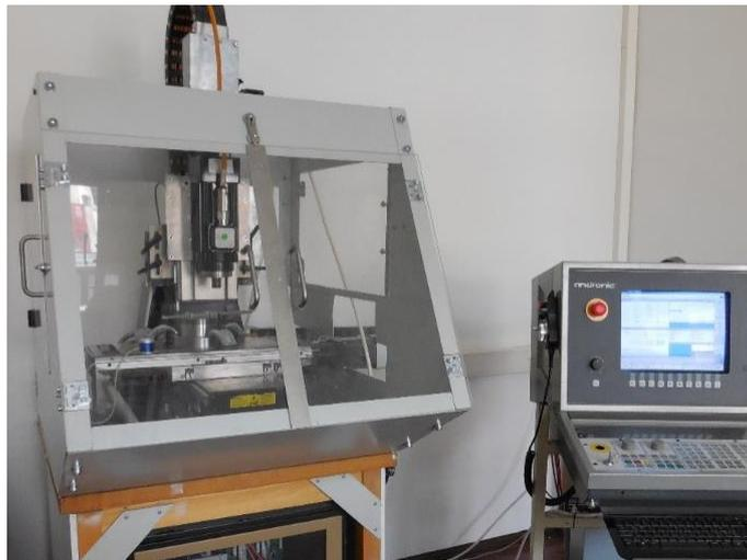
Abbildung 5: Modellfräsmaschine mit CNC andronic 3060 s
