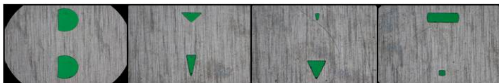
Abb. 3: Erzeugung verschiedener Elektrodenquerschnitte [4]
