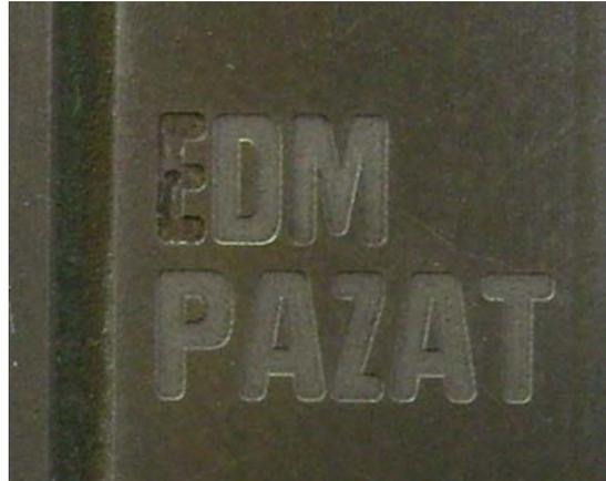
Bild 3: 2.5D-Konturbearbeitung zu Beschriftungszwecken in Hartmetall
