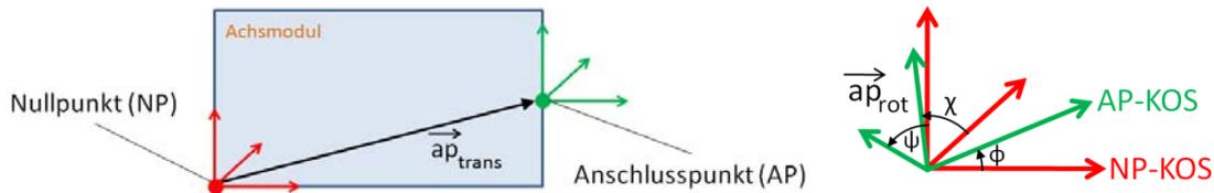
Abb. 2.2.1: Konvention der Koordinatensysteme für ein Achsmodul
