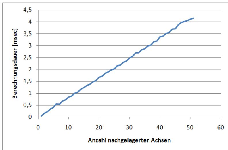
Abb. 3.2.1: Entwicklung des Berechnungsaufwandes am Beispiel eines Roboterarms mit 50 Gelenken
