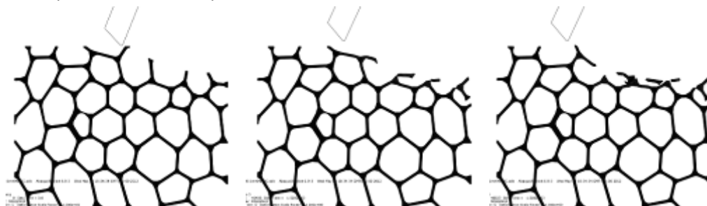
Abb. 4.3: Spanbildungsvorgang bei der 2D FE-Simulation des GleichlaufräSENS ( v_c = 100 m/min, f_z = 0,3 mm, a_e = 1 mm)
